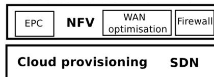
Figura 6.12. Uma Mini-nuvem na borda da rede móvel implementada com SDN como base para NFV. Fonte: [Vaquero and Rodero-Merino 2014]
