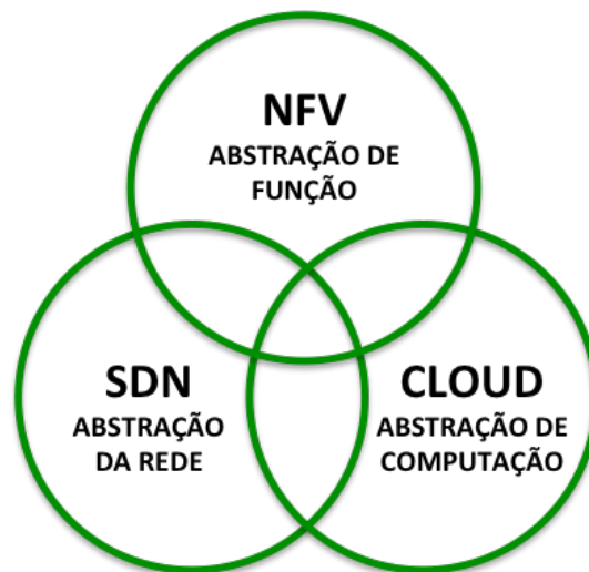
Figura 2.3. Relação entre NFV, SDN e Computação em Nuvem. Adaptado de Mijumbi et al. (2015)
